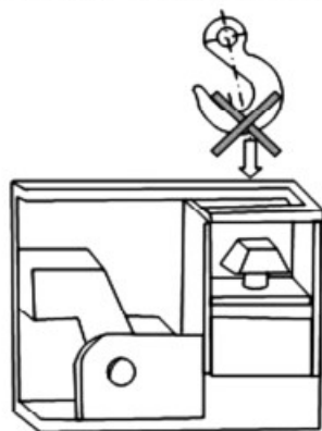
图 9 与台架式集装箱(折倒状)四周结构等处连接
